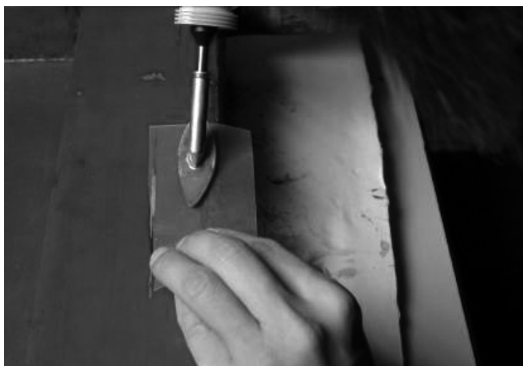
圖 53. 加熱整平作業
